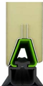
Placé à la base du panneau inférieur, ce composant THERMALSsafe supprime tout pont thermique entre l'intérieur et l'extérieur de la porte.
